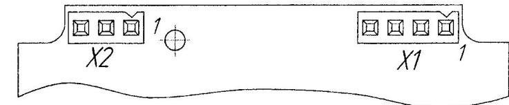
Рисунок В.2 – Расположение разъема X1 на плате модуля измерений и индикации ИБЯЛ.468157.007
