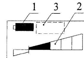
Рисунок 2.3 - Информация, отображаемая на индикаторе сигнализаторов СГГ-20Микро-04 в режиме индикатора-течеискателя
