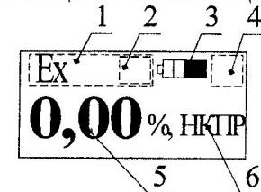
1 - химическая формула определяемого компонента или индикация срабатывания ПРЕДУПРЕДИТЕЛЬНОЙ или АВАРИЙНОЙ сигнализации; 2 - индикация режима питания ТХД; 3 - индикатор уровня заряда аккумуляторной батареи; 4 - индикация превышения значением содержания определяемого компонента верхнего предела диапазона показаний или индикация режима звуковой сигнализации; 5 - значение содержания определяемого компонента; 6 - единица физической величины определяемого компонента.
