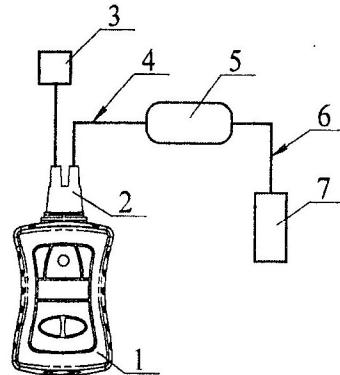
1 - сигнализатор; 2 - колпачок поверочный; 3 - клапан ИБЯЛ.306577.013; 4 - трубка ПВХ 4x1,5, длина 1 м; 5 - мех резиновый; 6 - трубка ПВХ 4x1,5, длина 1,5 м; 7 - газозаборник
