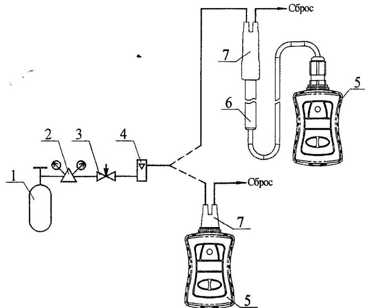
1 - баллон с ГСО-ПГС; 2 – редуктор баллонный; 3 - вентиль точной регулировки; 4 – индикатор расхода; 5 – сигнализатор; 6 – блок датчика; 7 - колпачок поверочный ИБЯЛ.301121.015 (для встроенного датчика) или ИБЯЛ.301121.010 (для блока датчика)
